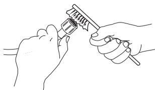
3. Zatim rukom odvijte crevo za dovod vode sa zadnje strane mašine. Kleštimi izvucite mrežasti filter iz ventila sa zadnje strane mašine i pažljivo ga očistite.
