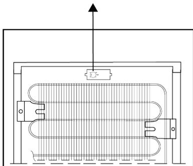
Termostat je nameščen na zadnji steni ohišja (glejte sliko zgoraj) in ga upravljate z gumbom termostata.
