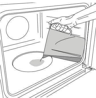
Za pokretanje funkcije Steam (Para) ulijte 200 ml pitke vode na dno pećnice. Funkciju odaberite okretanjem gumba za odabir u smjeru kazaljke na satu na odgovarajuću ikonu, a zatim okrenite gumb termostata u bilo koji položaj između 160 i 180°C (kako je predloženo ikonom).
