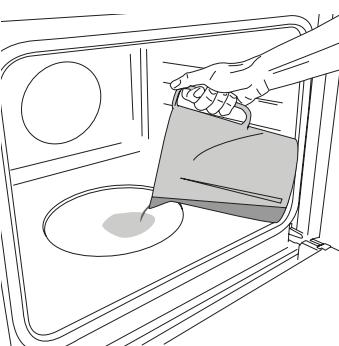
Pred vklopom funkcije uporabe pare na dno pečice naliite 200 ml pitne vode. Izberite funkcijo, tako da izbirni gumb zavrtite v smeri urinega kazalca na ustrezni simbol, gumb za nastavitev temperaturu pa v poljubni položaj med 160 in 180 °C (kot prikazuje simbol). Funkcija se bo zagnala, na zaslonu pa bo prikazan trenutni čas v dnevnu. Predgretje ni potrebno. Za končanje pečenja zavrtite izbirni gumb v položaj 0. Med kuhanjem s paro ne odpirajte vrat in nikoli ne dolivajte vode.
