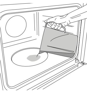
Da biste pokrenuli funkciju Steam (Para), sipajte 200 ml vode za piće na dno pećnice. Izaberite funkciju okretanjem dugmeta za biranje u smeru kretanja kazaljki na satu na željenu ikonu, a dugmeta termostata na bilo koji položaj između 160 i 180 °C (kao što pokazuje ikona). Funkcija se pokreće, a na displeju se prikazuje trenutno doba dana. Nije potrebno predzagrevanje. Za završetak pečenja, okrenite dugme za biranje na položaj 0.
