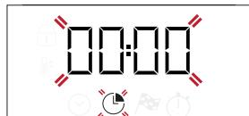
Χρησιμοποιήστε το **+** ή το **-** για να ρυθμίσετε το χρόνο ψησίματος και πατήστε το
