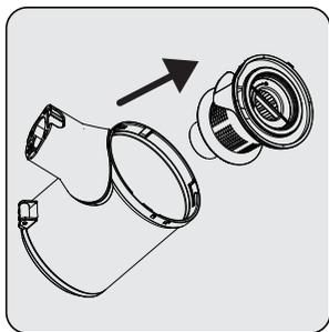
Izvucite EPA E10 i držač plastičnog filtera sa ručke EPA E10.
