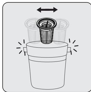
Uklonite prašinu sa filtera EPA E10 tapkajući ga o tvrdu površinu kao što je kanta za smeće ili to uradite pomoću četke.
