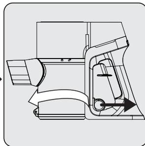
Da biste detaljno očistili filtere, uklonite telo posude za prašinu okretanjem u smeru kazaljke na satu dok lagano povlačite prsten posude za prašinu (4).
