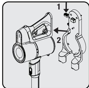
1- Pritisnite prekidač za otpuštanje uređaja (7) na priključnoj stanici za punjenje (8) nadole i istovremeno povucite uređaj prema sebi.
