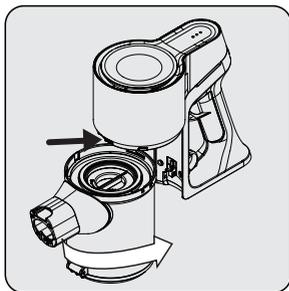
Provucite nazubljeni deo posude za prašinu do rupa na telu, a zatim podesite posudu okretanjem suprotno od kazaljke na satu dok ne čujete zvuk klika.
