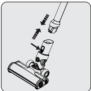
Pritisnite dugme za otpuštanje električne turbo četke (11) koje se nalazi na električnoj turbo četki (12) i pritisnite ga u smeru strelice prema cevi.
