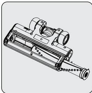
Uklonite prašinu s nje laganim tapkanjem po tvrdoj površini ili uklonite prašinu četkom. Ako se zaplete neka dlaka i sl., uklonite je tako što ćete je iseći.
