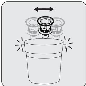
Uklonite prašinu sa metalnog filtera tapkajući ga o tvrdu površinu kao što je kanta za smeće ili to uradite pomoću četke.
